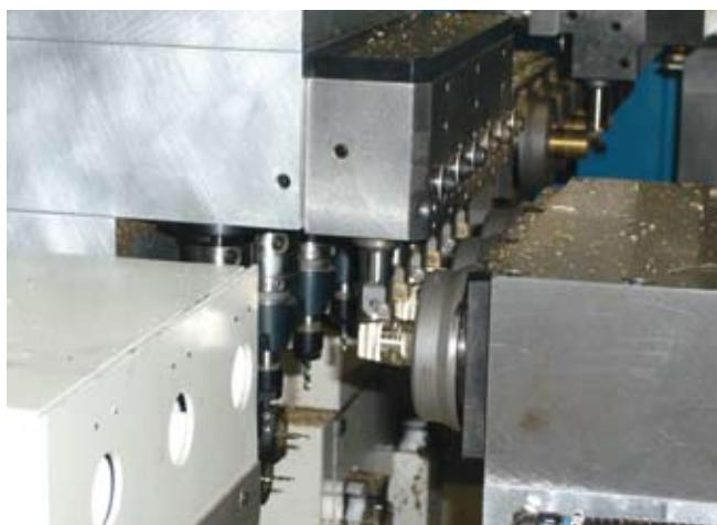
Les outils aux triples contre-broches permettent toutes les opérations de tournage, perçage, fraisage et taraudage sur l'arrière de la pièce.
