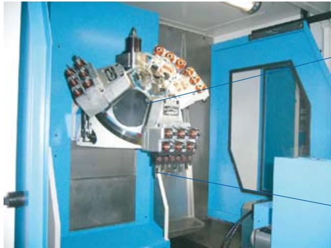
La zone d'usinage bien aérée permet l'utilisation d'une tête revolver Triax dotée de 8 stations à outils multiples.
