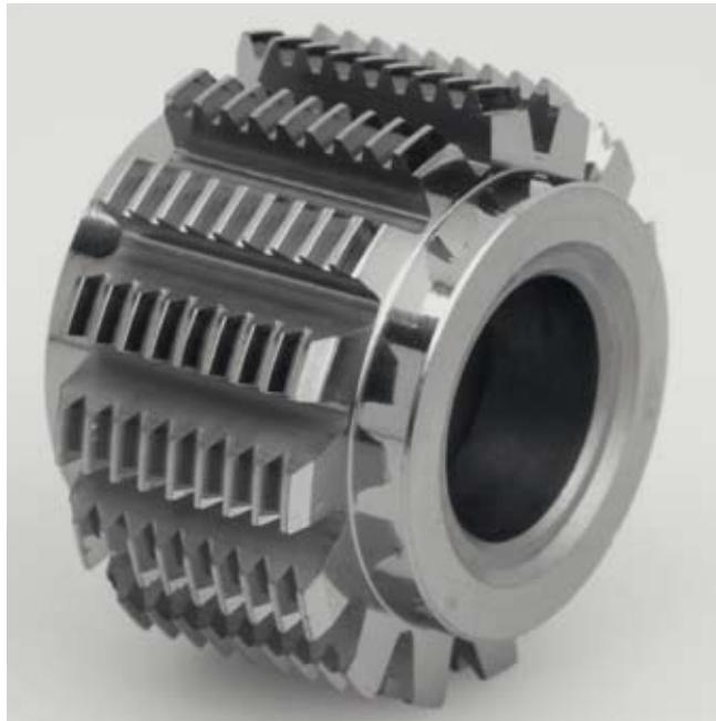
Gros plan sur le rayon concave minimum de 0,02 mm. Les procédés d'usinage "maison" permettent à l'entreprise de profiler des formes très complexes avec des rayons concaves minimum de 0,02 mm.
