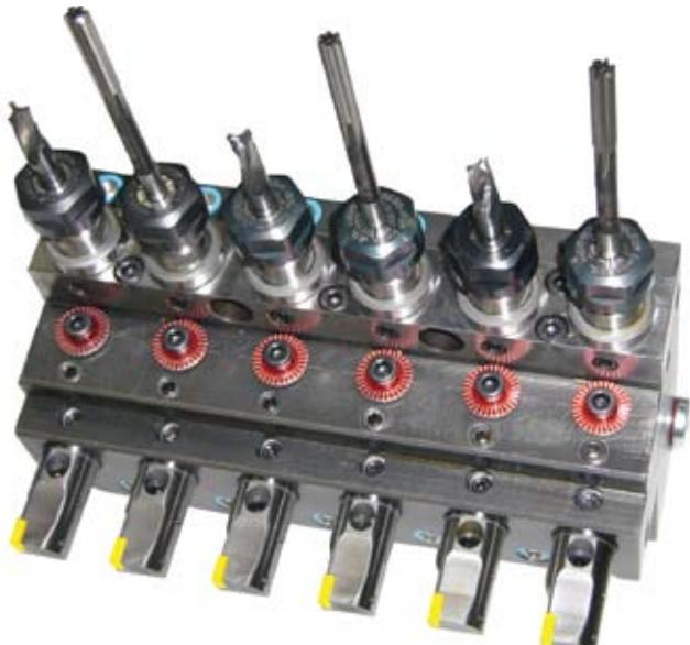
Exemple de bloc porte-outil fixe de perçage et tournage. Les broches modulaires et les porte-burins à changement rapide sont préglables. Les vis micrométriques permettent le réglage fin sur la machine.
