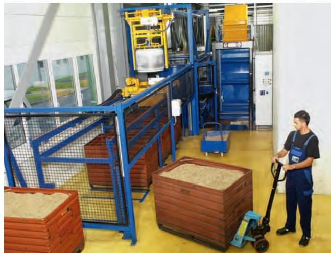
*Le passage à une huile de coupe unique a simplifié la récupération de l'huile, qui s'effectue désormais grâce à une centrifugeuse à copeaux entièrement automatique.*
