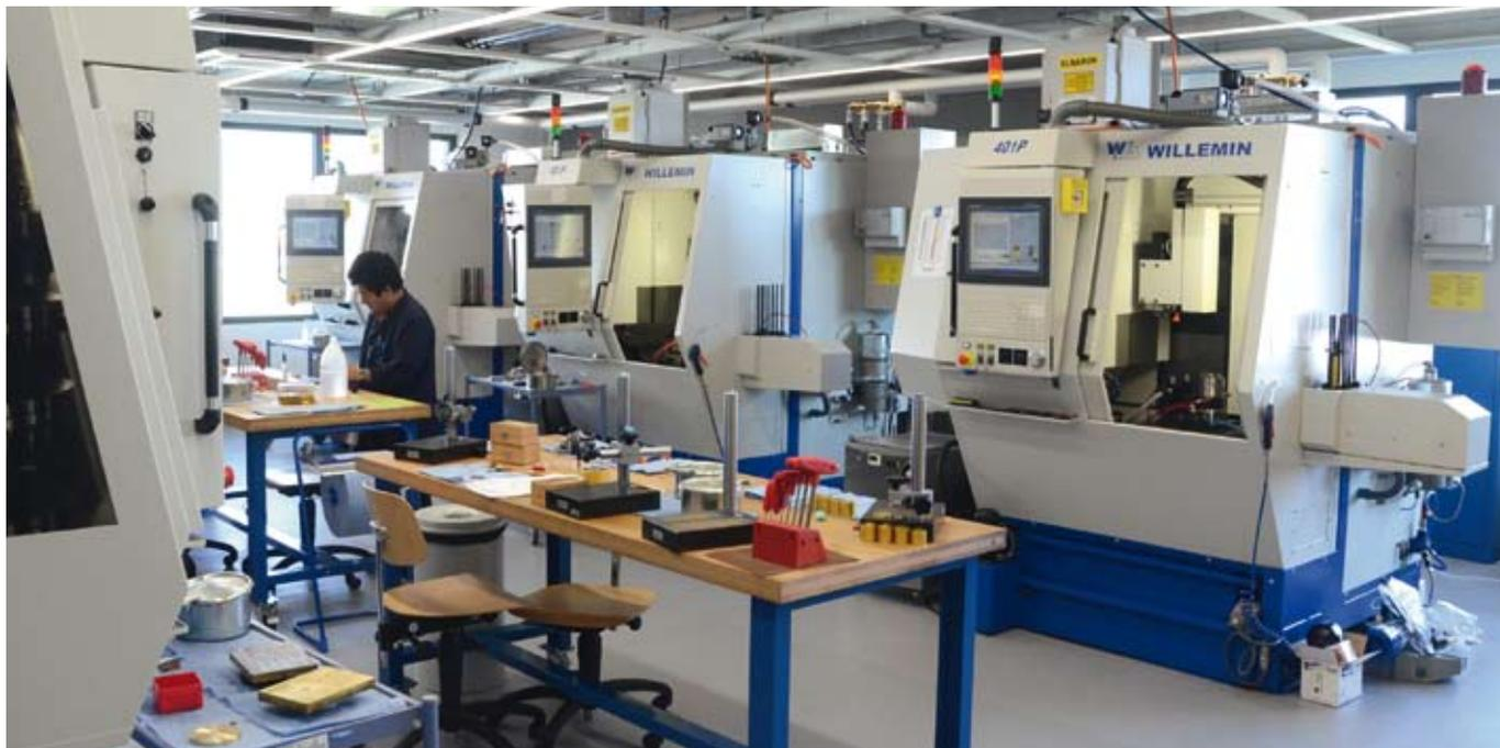
L'atelier "fraisage des complications" comporte six machines Willemin-Macodel, deux machines cinq axes et quatre trois axes.
