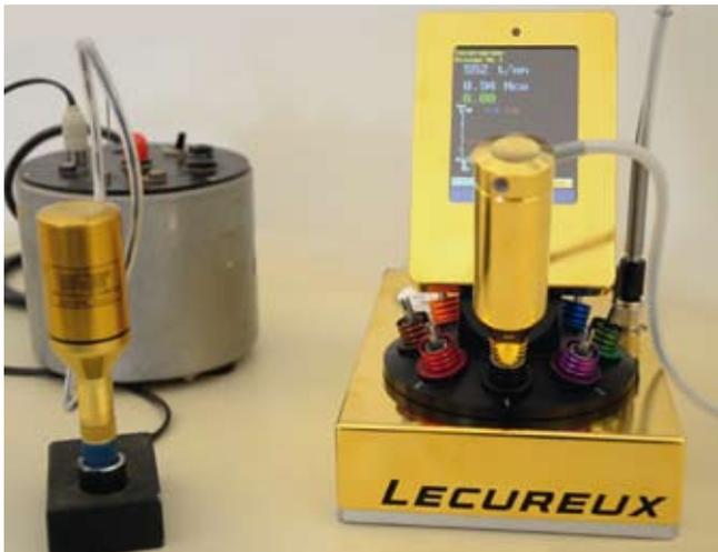
50 ans séparent ces deux tournevis électriques et les têtes ainsi que les embouts pour le changement rapide sont toujours compatibles. La nouvelle version commandée par touch screen offre de plus une connectivité complète pour le contrôle SPC des opérations de montage manuelles.
