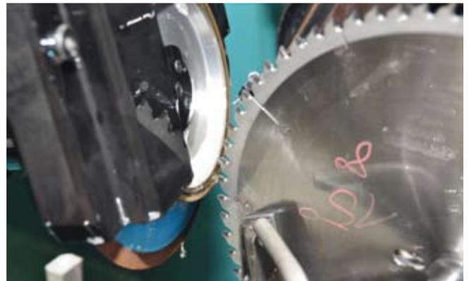
*Les activités d'Oertli Werkzeuge AG à Höri/ZH consistent notamment à rectifier, et donc à affûter, des lames de scies circulaires à dents rapportées en métal dur. L'entreprise obtient d'excellents résultats d'usinage avec l'huile Motorex Zoom Synt.*
