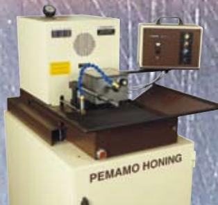
Machine de rodage de haute précision
