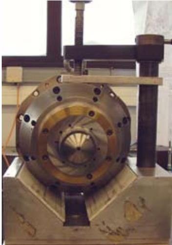
Precise France SA dispose d'un banc de test Fischer identique à celui installé en Suisse chez le fabricant. Le protocole de contrôle couvre les mêmes points que ceux testés sur les broches neuves et garantit la "qualité usine" au client.
