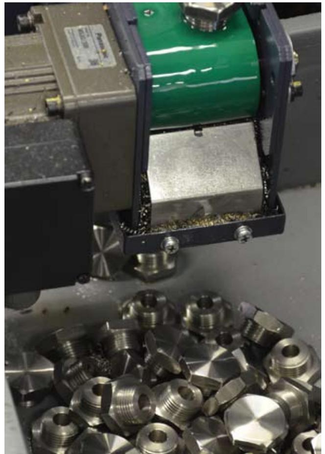
Après 4'500 pièces en inox, seule la plaquette subissant les contraintes de la coupe interrompue a dû être changée. L'usure des outils est réduite au minimum. Nach 4 500 Teilen aus Edelstahl musste nur das ununterbrochen schneidende Schneidplättchen ausgewechselt werden. Der Werkzeugverschleiß ist auf ein Minimum reduziert.
