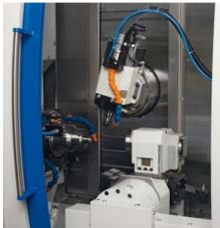
Centre d'usinage 508MT avec tourelle de reprise à 3 positions utiles (contre-broche, étau, contre-pointe).
