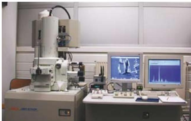
*Pour effectuer des analyses de résidus et déterminer précisément des polluants, l'entreprise peut compter sur son microscope électronique à balayage. Das Unternehmen kann sich auf sein Rasterelektronenmikroskop verlassen, um Analysen von Rückständen durchzuführen.*
