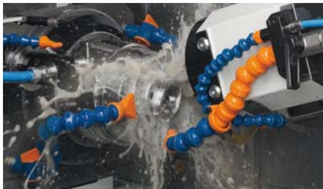
Fraisage-tournage sur centre d'usinage 508MT à partir de barre ou de lopins (barres Ø max 42 mm en standard, Ø 65 mm en option).
