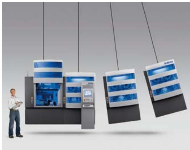
Conçu sous forme de modules, le système de transfert Multistep XT-200 peut évoluer en fonction du cycle de vie des produits. Chaque module constitue une unité de fabrication en lui-même. Parmi les segments de clientèle types de ce système, on peut citer : le secteur automobile et ses sous-traitants, l'industrie hydraulique et pneumatique, la robinetterie, le médical et l'usinage par enlèvement de copeaux. (Photo : Mikron)
