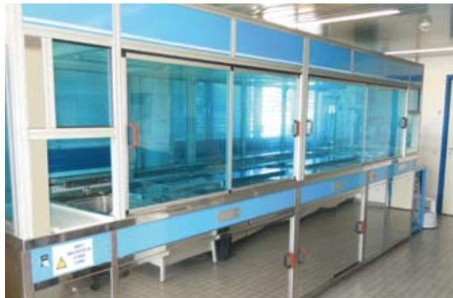
De manière à effectuer des tests en grandeur réelle, NGL Cleaning Technology dispose d'une machine de nettoyage à 9 bacs équipés d'ultrasons.
