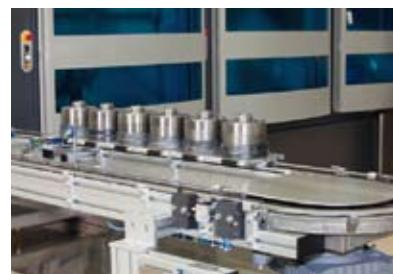
*Le système peut fonctionner de manière autonome pendant au moins une heure au moyen d'un convoyeur à bande.*
