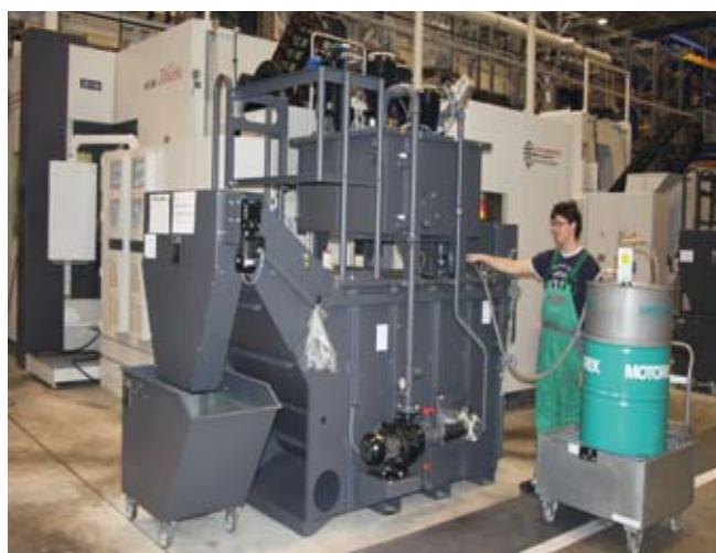
Réalimentation en Motorex Swisscool 7722 de la centrale de lubrifiant réfrigérant de l'un des deux nouveaux centres de fraisage CNC ultramodernes StarragHeckert.
