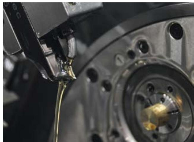
Le porte-outil de la *Tornos MultiSwiss 6x14* comporte désormais un trou d'aménée du liquide de coupe qui est dirigé avec précision jusqu'au point le plus avancé : entre le tranchant de l'outil et la pièce à usiner.
