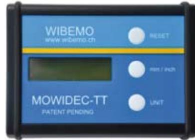
On ne peut plus simple, l'écran indique l'erreur au diamètre en micron et par une simple correction des offsets, celle-ci est compensée. Recentrer des broches devient un jeu d'enfant !
