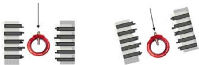
Mise en place au canon. L'axe vertical de la sonde doit être positionné dans le même plan que l'axe vertical de déplacement des peignes.
