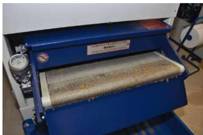
Un filtre à bande intégré filtre l'huile de coupe à 50 µ dans la plupart des cas. Le réservoir principal contient 880 litres d'huile de coupe. Un autre réservoir de 240 litres fournit aux paliers hydrostatiques une huile Ortho NF-X filtrée à 5 µ.
