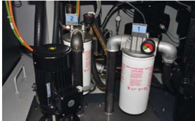
La MultiSwiss dispose d'emblée de deux filtres à huile fins. Grâce à un circuit bien étudié, il est possible de remplacer l'un ou l'autre des filtres pendant la marche, sans interruption de la production. La pression de l'huile dans la machine peut atteindre 80 bars.
