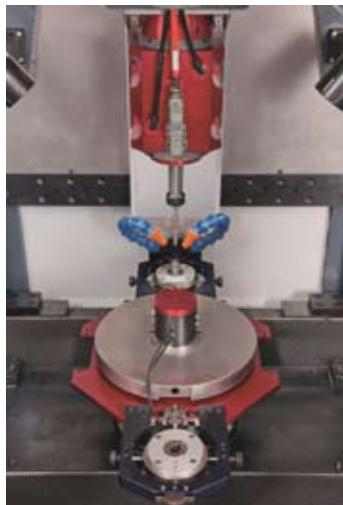
La coulisse verticale est motorisée par un moteur linéaire permettant un positionnement rapide du rotoir dans l'alésage et peut générer un mouvement de rodage jusqu'à 500 mouvements par minute.
