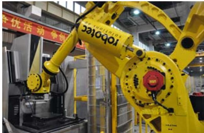
*Capable de manipuler des charges jusqu'à 700 kgs, le robot Fanuc charge les palettes System 3R sur les centres d'usinage avec une grande précision.*
