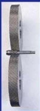
roulage de cannelures hélicoïdales
