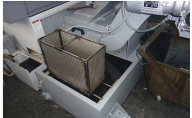
Autre aspect qui va simplifier la vie des utilisateurs : le filtre peut être installé en position d'égouttage, ceci même si un autre filtre est en position de travail.
