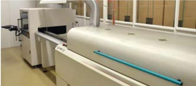
Dispositif permettant la réalisation de la tropicalisation (conform coating) des cartes.
