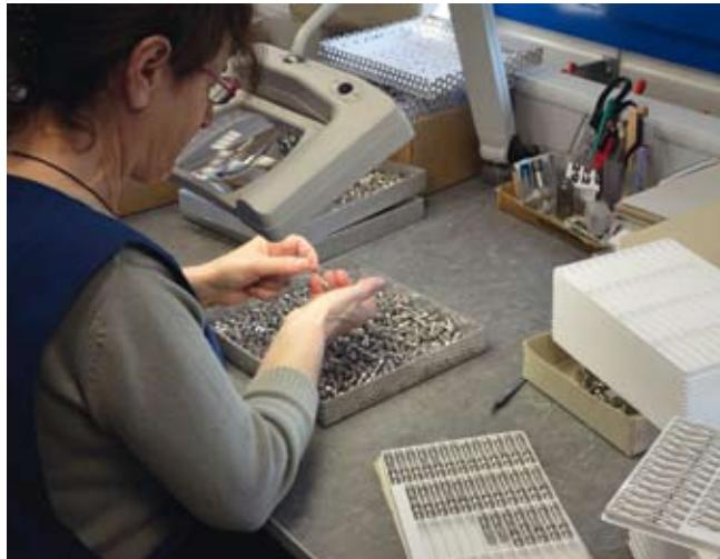
Selon les pièces, des contrôles visuels à 100% sont effectués. L'entreprise dispose de larges moyens de contrôle permettant par exemple de contrôler simultanément les deux faces opposées d'un produit.
