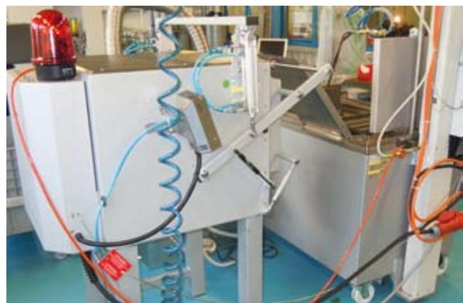
Installation de trempe permettant la réalisation de petites séries de pinces rationnellement.
