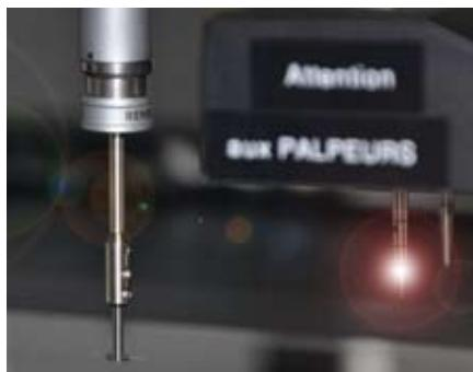
Le magasin de palpeurs offre de nombreuses possibilités complémentaires aux mesures optiques. Un dispositif équipé ainsi devient universel.
