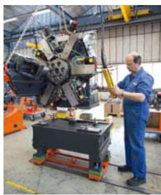
**L'illustration montre l'assemblage de précision du bloc multibroches et du châssis en fonte spéciale. En général, la fabrication d'un tour Tornos MultiSwiss est un véritable tour de force sur le plan mécanique et électrique.**
