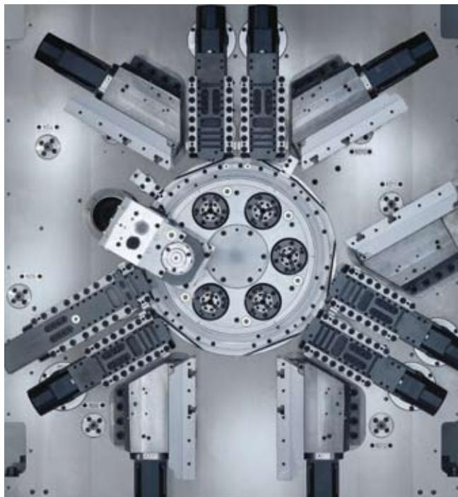
Avec le MS16C, multibroche à commande numérique d'index, le nombre de chariots de plongée et de chariots croisés est configurable en fonction des spécificités des clients.
