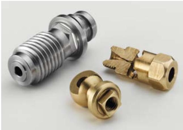
Le haut rendement combiné avec les différentes possibilités d'usinage : le perçage transversal, le filetage, le fraisage de contours et le polygonage.
