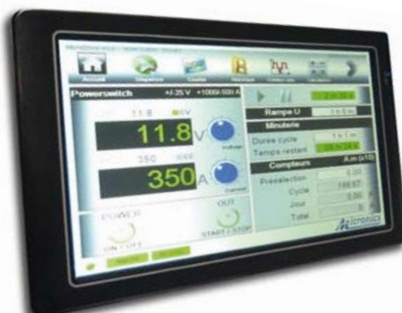
La nouvelle interface homme-machine développée par Micronics Systems permet une gestion et un suivi simplifié de l'alimentation électrique.
