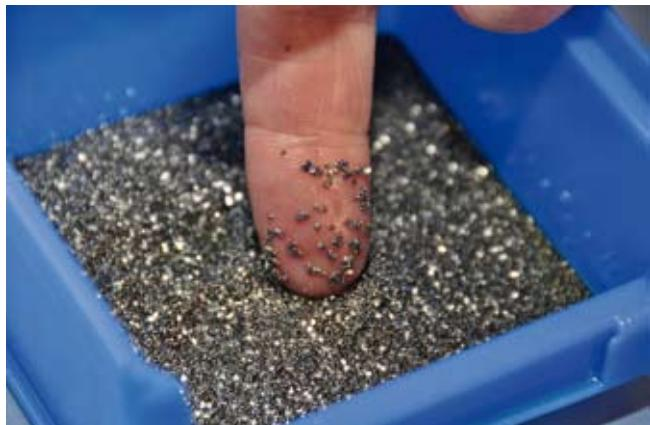
A l'œil nu, il est presque impossible de faire la distinction entre les nombreuses pièces de précision destinées à l'horlogerie, telles que des vis d'une longueur de 1,19 mm destinées à des mouvements mécaniques.
