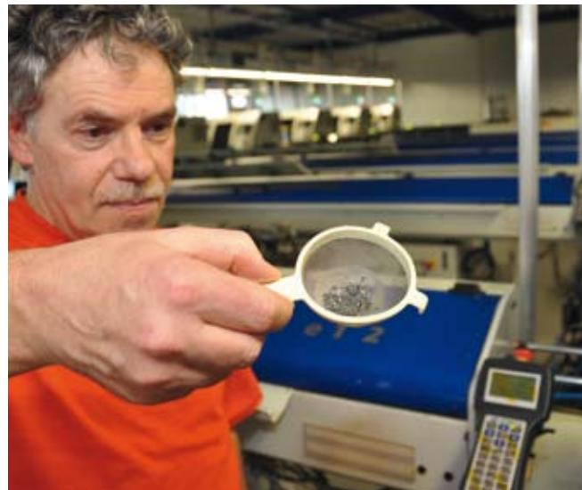
Ici, l'un des responsables qualité d'Easydec préleve sur une machine un échantillon de vis en vue de le mesurer.
