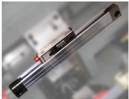
Tous les axes linéaires sont dotés de règles de mesure qui informent en permanence de la position réelle des axes.
