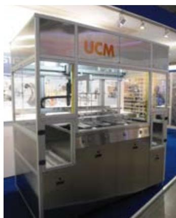
*Le système de nettoyage aux ultrasons, chargement et zone d'évacuation compris, ne fait que 2200 mm de long et 1150 mm de large et est équipé de deux cuves d'immersion pour le lavage et deux pour le rinçage.*
