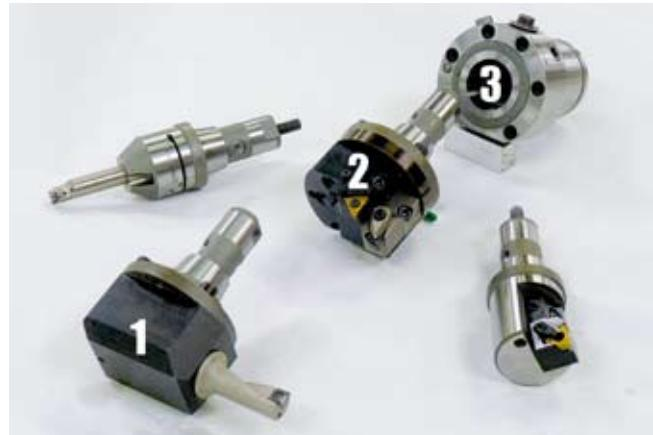
Système de porte-outil réglable : 1) Porte-burin interchangeable pour usinage intérieur. 2) Porte-burin interchangeable multi opération, tournage + filetage. 3) Douille porte-outil avec réglage intégré.
