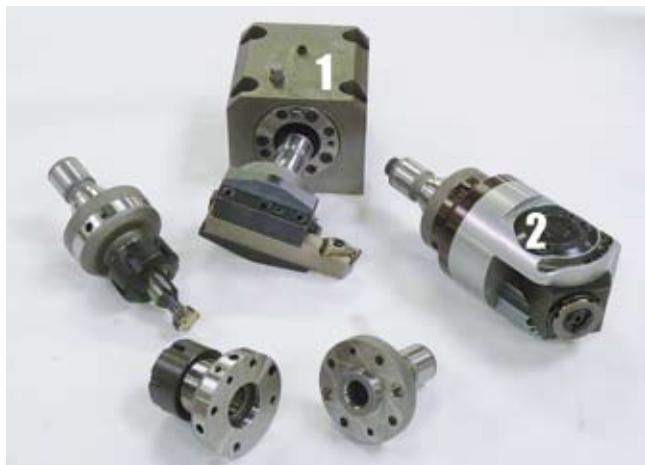
Avec le système de base, le Piboturn permet le montage de porte-burins gauche ou droite, d'un porte-pince ou d'un outil entraîné. 1) Pièce de réception montée sur tourelle standard pour outil fixe. 2) Porte-outil motorisé compact.
