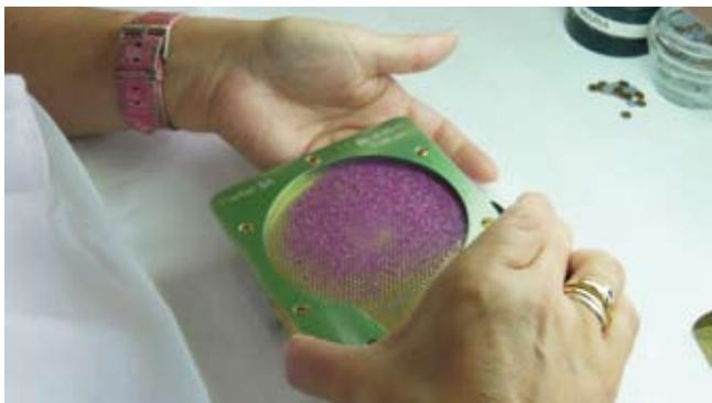
**Une fois les diamètres terminés, les pierres d'horlogerie sont fixées sur un support spécial et collées en place.**
