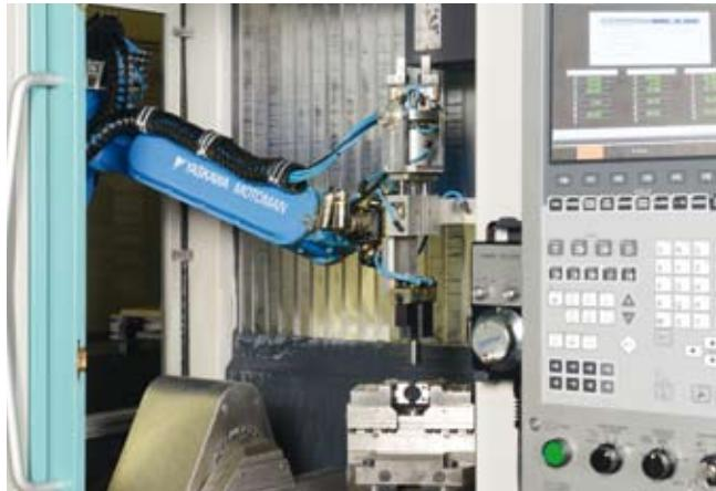
On utilise aujourd'hui des robots de manutention pour l'usinage mécanique.
