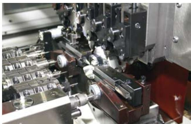
Dotée de série de 12 outils montés sur trois systèmes (bascule, vertical et frontal), la machine offre de nombreuses options pour l'adapter aux pièces à réaliser.
