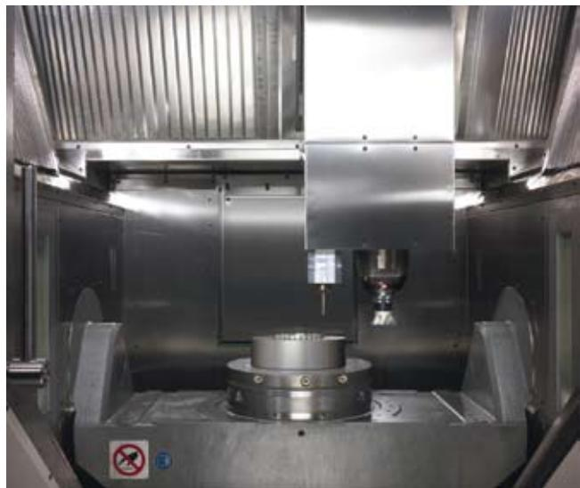
Espace de travail du centre d'usinage 5 axes avec technologie MIM intégrée.
