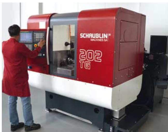
Avec la 202TG, Schaublin crée une nouvelle catégorie de machines qui autorise les opérations combinées de tournage et de rectification en un serrage. Les fabricants de pièces de haute précision l'ayant déjà vue sont très intéressés.
