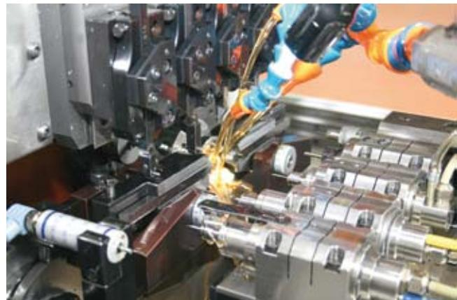
La combinaison de la bascule pour les deux outils de finition et des outils verticaux permet de répartir les opérations harmonieusement et l'approche des outils en temps masqué.
