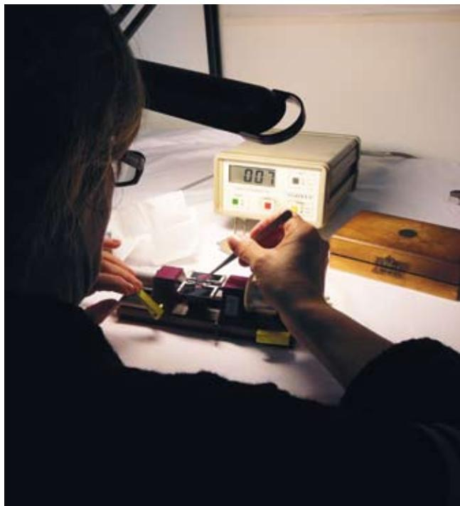
Selon les besoins, l'entreprise dispose de moyens de contrôle simples qui lui permettent de contrôler 100% de la production dans des tolérances au micron.
