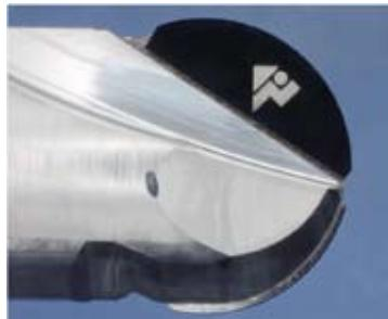
Bei diesem PKD Fräser mit Radius 0,5 mm wird die Formgenauigkeit innerhalb von 2 $\mu$ m gehalten und eine Oberflächengüte von Ra 0,099 erreicht!
