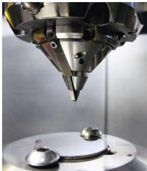
Le nouveau porte-électrode de précision Sarix SP12, assure un serrage sans jeu et répétable de l'électrode. En production le faux-rond de l'électrode est inférieur à 1 micron et est constant, même lorsque la pince est changée ou l'électrode avancée.
