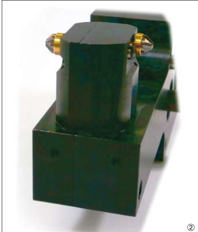
Le centrage automatique par un système flottant permet le chanfreinage sans risque de casser des outils dans l'usinage de pièces forgées.
