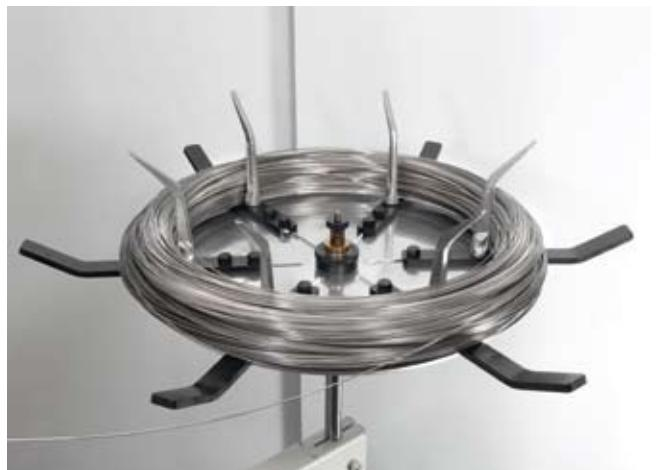
Au contraire d'une décolleteuse alimentée par un ravitaillleur, les machines escomatic sont équipées d'une couronne de matière et peuvent travailler beaucoup plus longtemps sans interruption.
