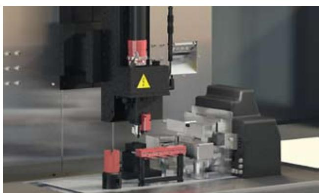
La nouvelle SX200 comprend la 4ème génération de commande avec un générateur de d'impulsions ultra fines SX-UFPS04.
