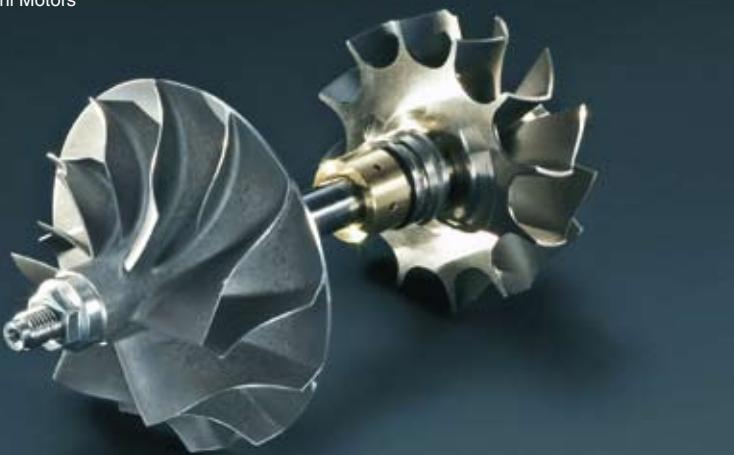
Les turbocompresseurs des moteurs de série atteignent des régimes de 300.000 t/min. et sont soumis à des contraintes thermiques extrêmement élevées : „Motorisation“ du Mitsubishi Lancer Evo 10 (version Japon).
