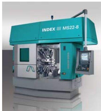
Les machines multibroches CNC d'Index peuvent être configurées selon les exigences des clients en termes de nombre de coulisses-croisées, d'axes Y et de broches synchrones.
