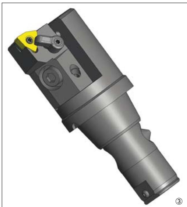
Le système Piboturn permet l'adaptation de porte-burins à gauche ou droite pour le tournage extérieur, de porte-burins de tournage intérieur, de porte-burins combinés, porte-outils de forage ou porte-pinces tourelle. Sur une tourelle de même dimension, on fixe 12 outils VDI 30 et 16 outils Piboturn, soit 33% d'outils en plus.
