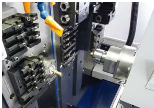
Swiss ST 26 possède une large zone d'usinage accessible des deux côtés.
