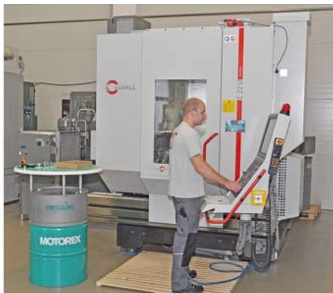
La roue de rotor a été réalisée sur un centre d'usinage 5 axes Hermle C 22 U dynamic.
