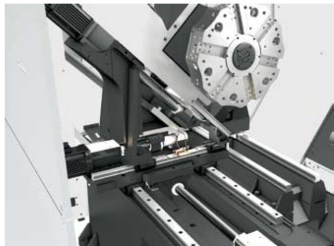
Haas n'emploie que des vis à billes et guidages de première qualité issus des meilleurs fabricants. Les vis à billes sont ancrées aux deux extrémités et font l'objet d'une inspection rigoureuse garantissant leur parallélisme parfait avec les guidages d'axe.
