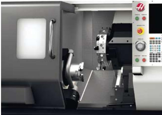
Les broches des modèles ST présentent un nouveau montage de palier qui se veut 20 % plus rigide que les modèles précédents, et génèrent une expansion thermique réduite de moitié.
