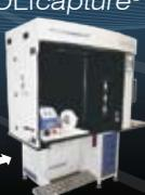
Cellule d'acquisition pour le polissage robotisé sans programmation,
