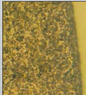
Photographie d'une couche de diamant synthétique de 15 µm
