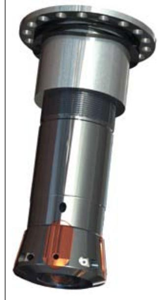
Le principe de base des canons Master assure un parfait parallélisme entre la surface de guidage du mors et la barre. Doté d'un système de compensation (ressort), le canon Master assure un guidage extrêmement précis même en cas de barre présentant de fortes variations au diamètre (jusqu'à 7/10ème de mm).
