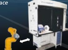
Cellule d'acquisition pour le polissage robotisé sans programmation,
