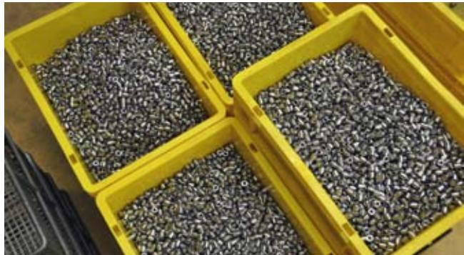
*La qualité gagne en visibilité, grâce à un contrôle documenté de tous les lots de production. Outre la masse, d'autres caractéristiques telles que la qualité de surface (valeur Rz = ondulation et rugosité) sont aussi déterminées.*
