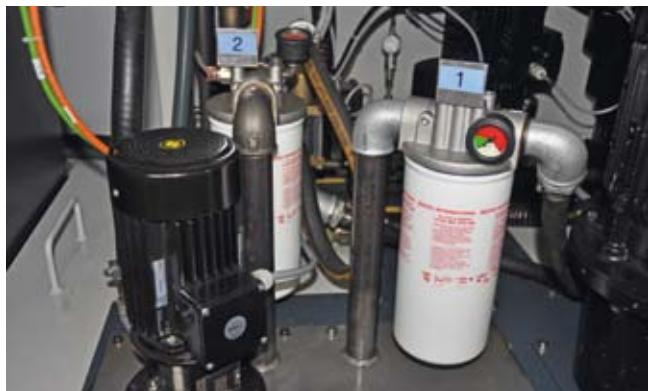
*Outre un filtre à bande, le tour Multiswiss 6x14 intègre aussi plusieurs filtres internes, pour une filtration de l'huile jusqu'à 5 µ. Cet aspect est particulièrement important pour le palier hydrostatique des 6 broches.*
