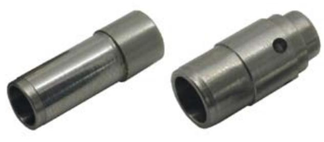
Exemple de 2 pièces pour conditionneurs produits avec Mikron Multistar CX-24.
