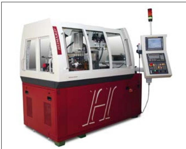
Humard Automation SA utilise les compétences en micromécanique de Seuret SA pour réaliser la Dec'Humard. Avec cette machine qui complète son offre de révision, le groupe offre des produits complémentaires cames et CN pour couvrir tous les besoins dans l'usinage de très haute précision dans les petits diamètres.
