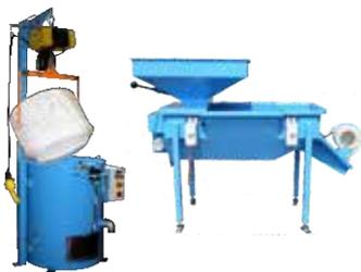
Maschinen zur Spänaufbereitung
