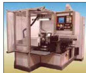
Vollautomatische 5-Achsen Anfasmaschine
