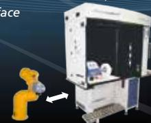
Cellule d'acquisition pour le polissage robotisé sans programmation,
