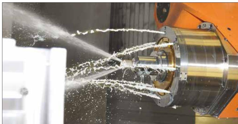
Grâce à l'agencement particulier de ses axes, la tête trigonale peut pivoter sur cinq faces pour adopter une inclinaison comprise entre -15 et +105°. Avec un couple de 450 Nm, la motobroche est capable d'effectuer n'importe quelle tâche.
