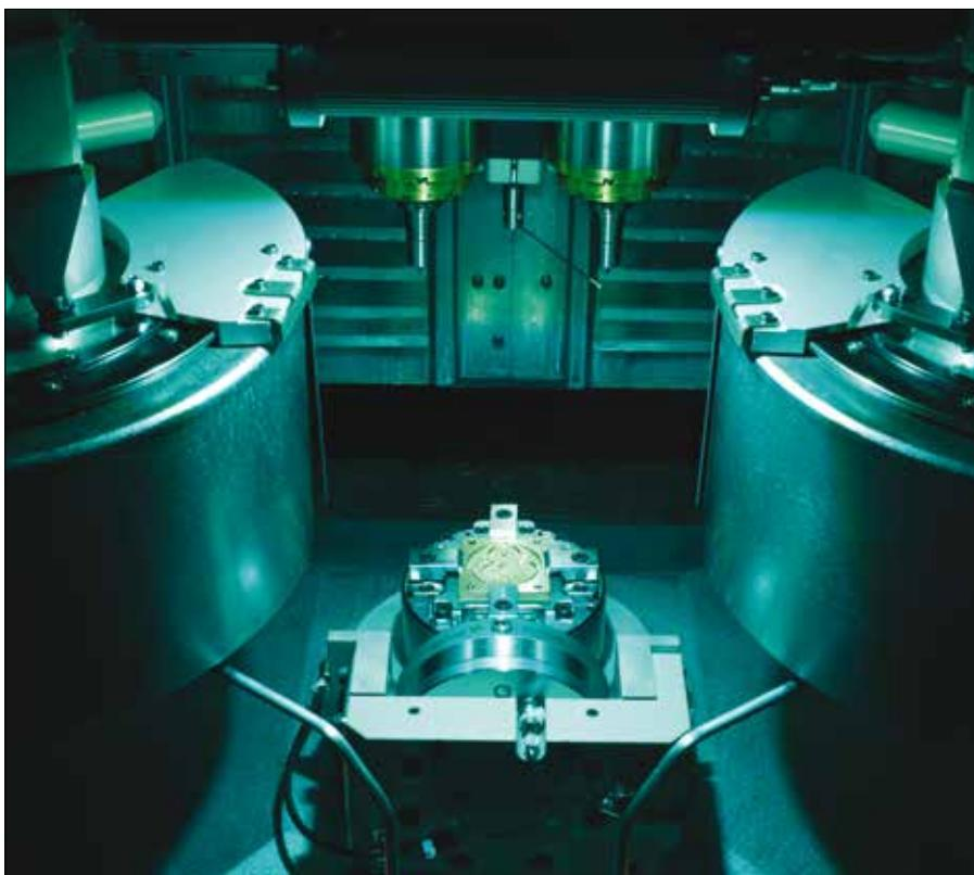
Dotée de 2 électro-broches (max 60'000 t/min.) et de deux magasins d'outils, la s100mono maximise l'utilisation des temps masqués.
