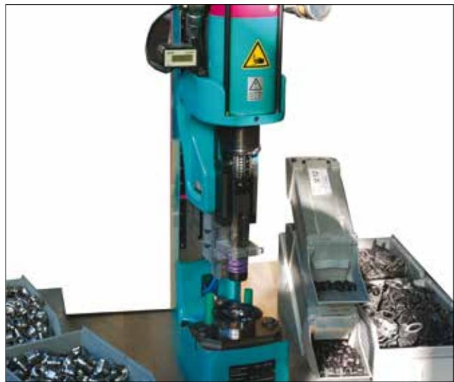
Presse pneumatique Tox-FinePress PFL, avec laquelle les plateaux porteurs sont sécurisés sur les soupapes d'auto-cuisson avec le support de la membrane.
