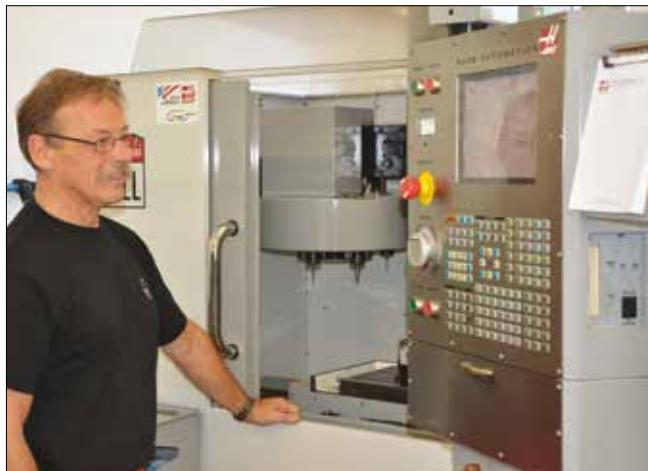
Directeur très créatif, M. Haas est également passionné par la mécanique et sa machine Super Mini Mill lui permet de réaliser l'ensemble des usinages nécessaires à la réalisation des pièces ou des moules destinés à ses produits.
