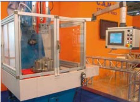
Cette machine est la seule mortaiseuse verticale du marché construite et réalisée sur les bases d'une machine-outil moderne comprenant Vis à billes + codeurs + CNC à commande simplifiée.
