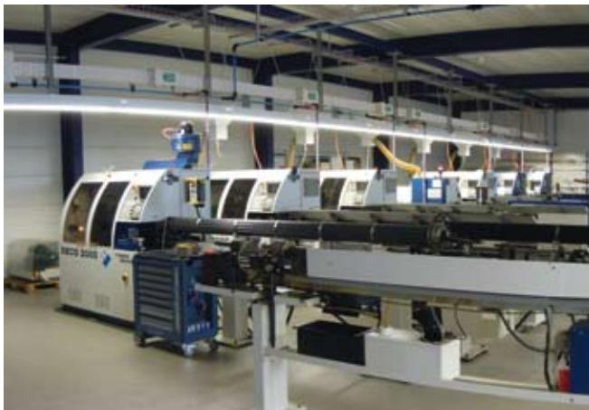
Les ateliers de easyDec sont vastes et bien éclairés, chaque machine dispose d'un système d'évacuation des brouillards d'huile avec récupération intégrée de l'huile.
