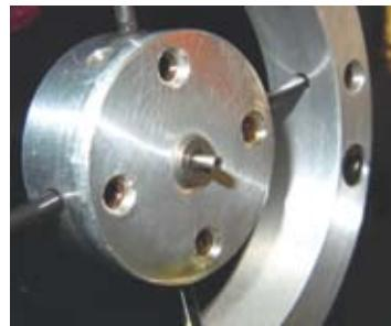
Gros plan sur le support flexible de pièce. Au centre on voit l'outil qui dépasse de la pièce à usiner.
