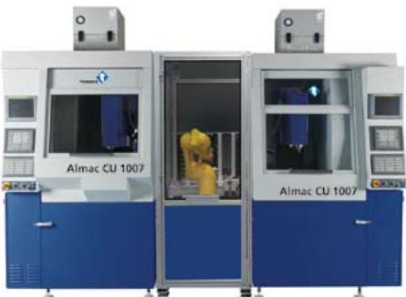
Le centre d'usinage CU1007 est modulaire. Evoluant au gré des besoins de ses clients, la solution CU1007 peut intégrer deux centres reliés par un robot. Le tout bien entendu suivi avec efficacité par Clipper.
