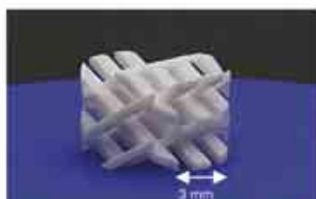
Le moulage par injection permet de mettre en forme des pièces très ajourées dans des matériaux difficilement usinables comme la céramique ou le titane
