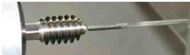
Cette pièce est percée à l'aide de la haute-pression et d'une mèche à une lèvre (Botek). L'huile est amenée dans le trou à très haute pression par le biais d'un canal à l'intérieur de la mèche.
