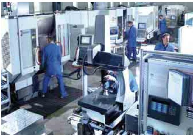
Les trois C 40 U sont des centres de production autonomes pour les usinages universels et flexibles 5 axes/5faces et de pièces 3D.
