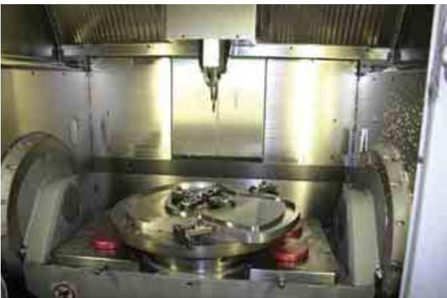
La zone d'usinage largement dimensionnée du C40 U: Usinage dur d'une pièce complexe (came plate) serrée sur la table numérique rotative (4ème et 5ème axes) d'un diamètre de 420 mm. 2 axes sur la pièce, 3 axes (X, Y, Z) sur l'outil.
