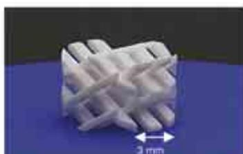
Le moulage par injection permet de mettre en forme des pièces très ajourées dans des matériaux difficilement utilisables comme la céramique ou le titane
