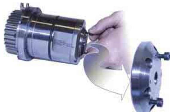
Réglable par l'avant, le canon à trois positions est très simple à utiliser et très flexible. Diese von vorne einstellbare Führungsbuchse mit drei Positionen ist äußerst einfach und flexibel in der Anwendung.
