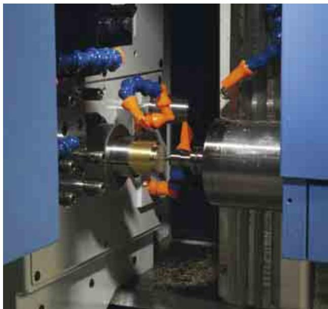
Regard sur la broche principale : la machine est prête à usiner la face une d'une nouvelle platine directement sur la barre.
