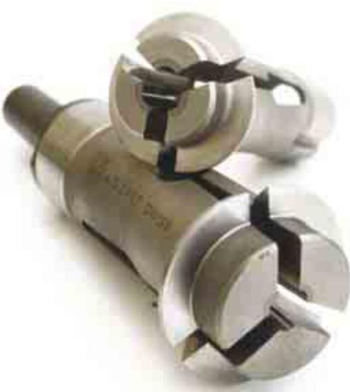
La pince à grande ouverture permet de prendre en contre-opération une pièce présentant un diamètre plus fort devant et plus petit derrière et d'effectuer le serrage sur le petit diamètre.
