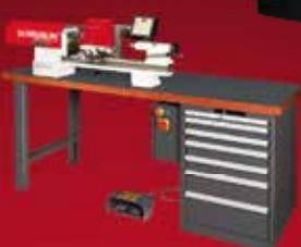
Tours conventionnels avec convertisseurs de fréquence et moteurs intégrés
