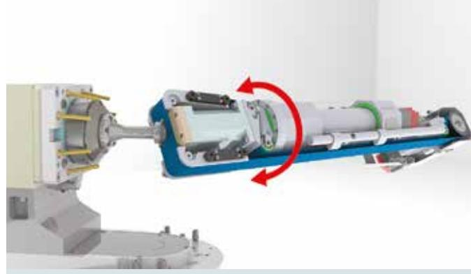
Reco-CT500: Satinage rotatif CNC 6 axes simultanés.
