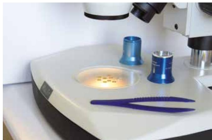
Des tests en laboratoire sont effectués pour déceler d'éventuels résidus d'humidité, de graisse ou de produits lessiviels.
