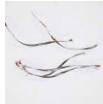
L'insertion d'un brise copeau dans le foret réduit sensiblement leur longueur et permet ainsi d'éviter les risques de rayures sur les pièces.
