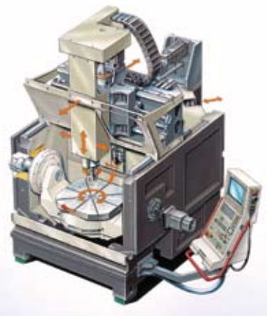
Design du C40 U et sa conception en portique. Grundaufbau der C 40 U in modifizierter Gantry-Bauweise. Basic design of the C 40 U in the modified gantry construction.
