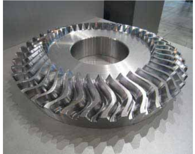
Pignon conique droit avec engrenage en cissoïde (engrenage en S) ne pouvant être produit que par fraisage.
