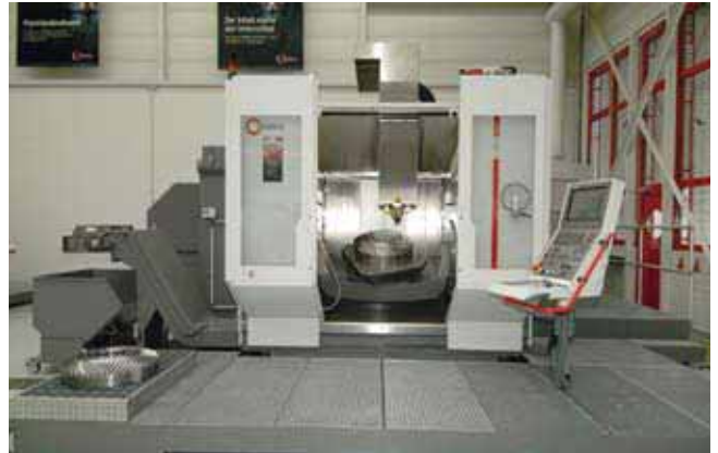
Centre d'usinage 5 axes haute puissance C 50 U dynamic usinant un pignon conique droit de Ø 800 mm.
