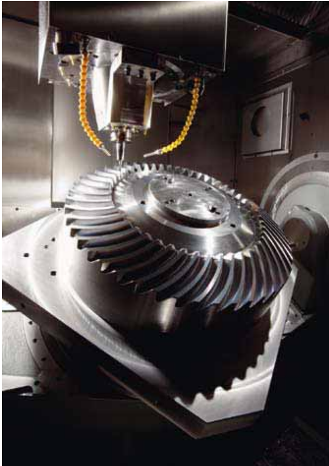
Usinage simultané à 5 axes d'un pignon conique droit de Ø 800 mm. 5-Achs Simultanbearbeitung eines Stirnkegelrades Ø 800 mm. 5-axis simultaneous machining of a cylindrical bevel gear Ø 800 mm.
