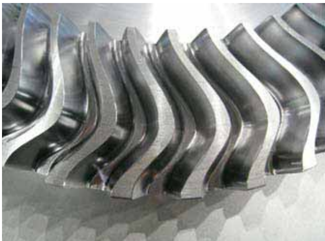
Segment d'un pignon conique droit avec engrenage en cissoïde (engrenage en S). Segment eines Stirnkegelrades mit Kosinusverzahnung (S-Verzahnung). 5 shows a segment of a cylindrical bevel gear with cosine toothing (S-toothing) Bildbeschreibungen.
