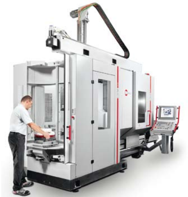
Le centre d'usinage C 22 U dynamic avec le système de changement de palettes PW 150 adapté latéralement, au premier plan le poste d'équipement.
