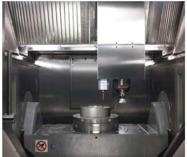
Espace de travail du centre d'usinage 5 axes avec technologie MIM intégrée.
