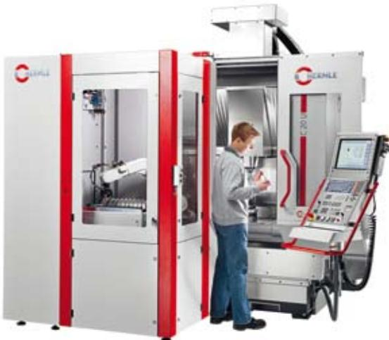
Le système de robot RS 05 adapté à un centre d'usinage à 5 axes C 20 U : la solution d'automation sur 2 m<sup>2</sup> conçue pour la technique médicale et la mécanique de précision.
