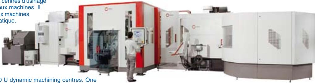
je nach Typ zwei oder drei Stück und mit Speicher dann zwischen sieben und 21 Paletten. Mit den Palettenwechslern wird hauptzeitparalleles Rüsten Realität und die Fertigung kann je nach Bearbeitungszeit pro Teile über einen bestimmten Zeitraum mannarm/mannlos erfolgen. Darüber hinaus lassen sich zwei und mehrere BAZ's zu FFS Flexiblen Fertigungssystemen verketten.
