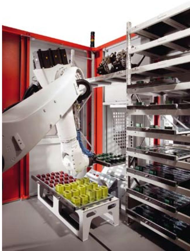
Système de robot RS 2 Kombi. Lors de l'entrée d'une palette de matrice avec plusieurs pièces brutes. Un changement de préhenseur permet au robot d'entrer la pièce brute directement dans la zone de travail du centre d'usinage et, après l'usinage, de la redéposer sur la matrice.
