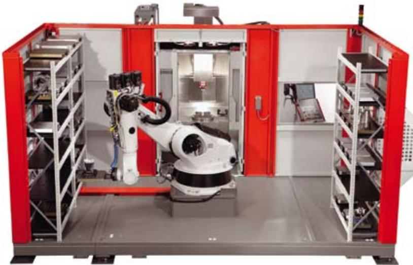
Système de robot avec deux magasins de palettes, lors du chargement d'un centre d'usinage à 5 axes haute performance (la paroi avant de l'enveloppe de protection a été enlevée pour explication).
