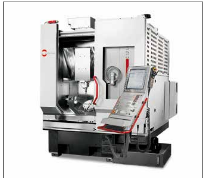
Centre d'usinage C 12 U dynamic complet avec table circulaire pivotante CN de Ø 320 mm.
