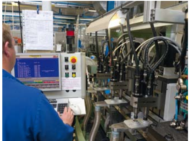
Selon les opérations à effectuer, les bandes avancent pas à pas sur chaque station de travail pour subir les opérations nécessaires.
