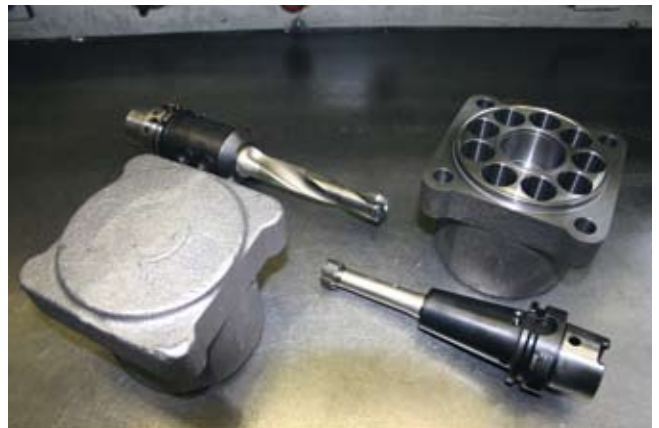
Corps de pompe hydraulique en GGG40. Pièce non terminée et terminée.
