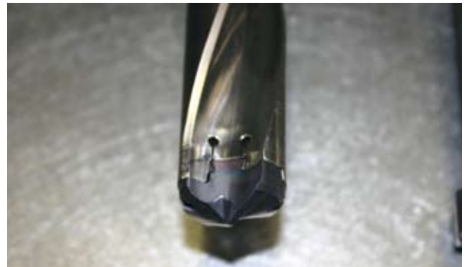
Uтил de perçage Chamdrill avec son corps standard et sa tête interchangeable. Chamdrill-Bohrwerkzeug mit Standardschaft und dem austauschbaren Wechselkopf.
