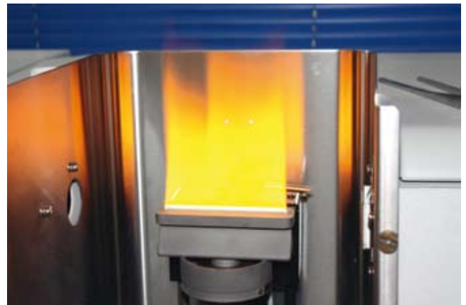
Le spectromètre d'absorption atomique permet de déterminer la concentration de certains métaux dans un échantillon.
