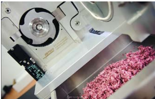
Analyses des allergènes et toxiques : broyage d'un échantillon avant analyse. Allergen- und Schadstoffanalysen: Vor der Analyse wird eine Probe zermahlt. Analyses of allergens and toxins: crushing of a sample prior to analysis.
