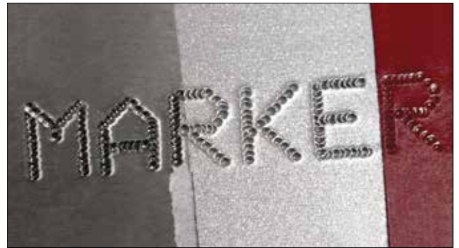
De gauche à droite: Marquage sur une pièce en acier, marquage après sablage, marquage après sablage et application d'une couche de laque.
