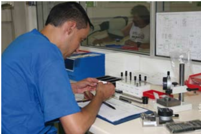
Les mesures avec des méthodes manuelles requièrent plus de temps avec un enregistrement manuel des résultats. Jean-Philippe Renaud, technicien de mesure, en train d'inspecter et de mesurer une vis pour implanter dans le genou. Die manuellen Messungen benötigen mehr Zeit, zudem müssen die Ergebnisse von Hand aufgezeichnet werden. Der Messtechniker Jean-Philippe Renaud bei der Inspektion und Messung einer Schraube für ein Knieimplantat. Measurement by manual methods take more time with manual recording of results. Jean-Philippe Renaud, metrology technician, inspecting and measuring a screw for a knee implant.
