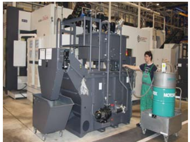
Réalimentation en Motorex Swisscool 7722 de la centrale de lubrifiant réfrigérant de l'un des deux nouveaux centres de fraisage CNC ultramodernes StarragHeckert.
