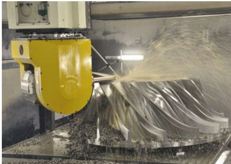
Construite comme exemplaire unique, une roue à aubes destinée à un compresseur utilisé notamment dans l'industrie de transformation du pétrole, s'est prêtée parfaitement pour un test de performance du nouveau lubrifiant réfrigérant Magnum PMC® 300.
