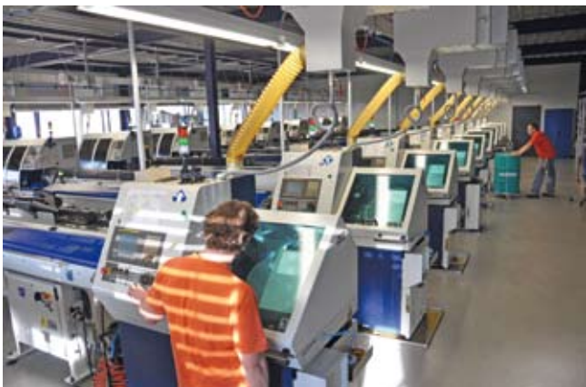
Un nombre impressionnant de machines de décolletage CNC de Tornos, ici au premier étage, assurent la fabrication des pièces 24h/24.
