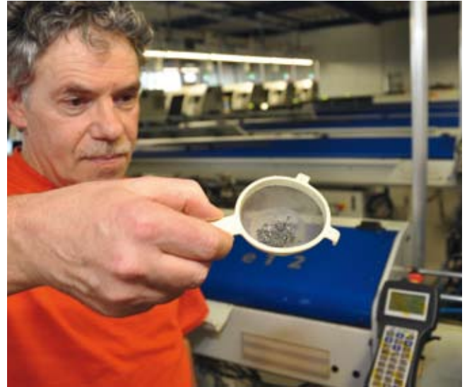
Ici, l'un des responsables qualité d'Easydec prélève sur une machine un échantillon de vis en vue de le mesurer.
