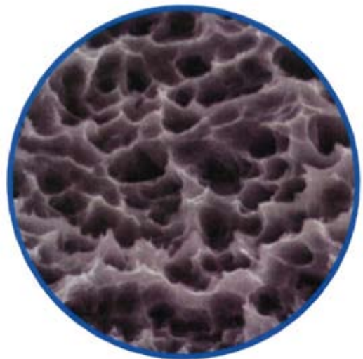
6. Photo de la surface de l'implant, agrandie 5000 fois, effectuée par un microscope électronique à balayage. Foto der Implantatsoberfläche, in 5000-facher Vergrößerung durch Rasterelektronenmikroskop. Surface of the implant magnified 5000 times by a scanning electron microscope.
