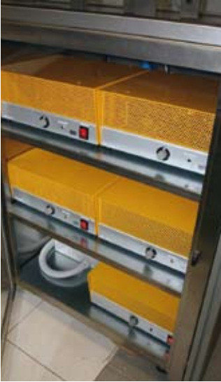
8. Les générateurs d'ultrasons. Les cinq cuvettes sont dotées d'ultrasons Die Ultraschallgeneratoren. Die fünf Becken sind mit Ultraschall ausgestattet.
