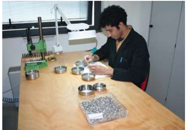
5. Après le premier lavage, chaque pièce est soumise à un contrôle manuel et à un parachèvement en enlevant à la main les éventuelles bavures d'usinage. Nach der ersten Reinigung wird jedes Werkstück einer Kontrolle von Hand unterzogen. Abschließend werden eventuelle Schmierrückstände manuell entfernt. After the first wash, each part is manually checked and possible burrs are manually removed.
