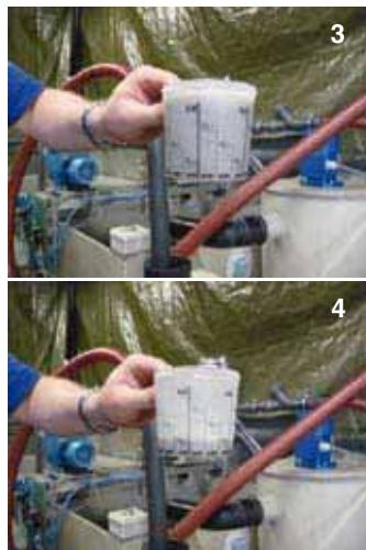
der Ingenieur-Chemiker Philippe Pousaz. „In einem zweiten Schritt spielt das Flockungsmittel (4) gewissermaßen die Rolle eines Fischernetzes, das die „Fische“ einfängt, wodurch klares Wasser erhalten wird, an dessen Grund sich ein Schlamm ablagert, der hierauf auf einfache Weise abgepumpt werden kann. Um dieses Resultat zu erzielen, genügen praktisch homöopathische Dosen. Rund 50 Liter Reaktionsmittel im Monat für 500 Kubikmeter behandeltes Wasser.“
