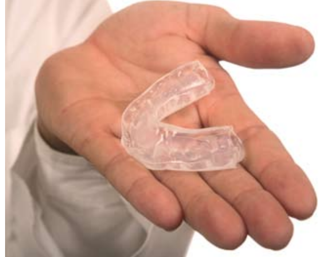
Ce protège-bouche est un exemple de produit fini réalisé par thermoformage.
