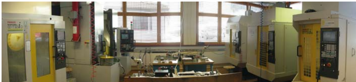
Ateliers des centres d'usinage. Le 100% des pièces prismatiques utilisées dans les micro-montages est usiné à l'interne. Werkstätten der Bearbeitungszentren. 100% der für Mikromontagen eingesetzten prismatischen Teile werden intern bearbeitet. Machining centre workshops - 100% of prismatic parts used in micro-assemblies are machined in-house.
