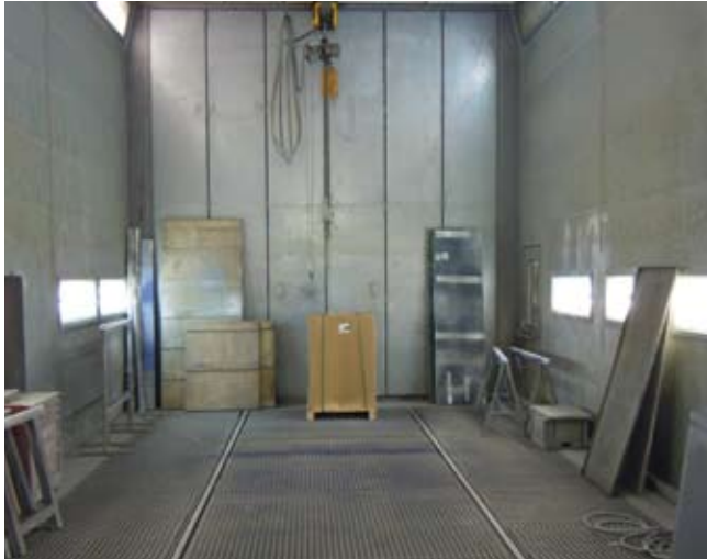
L'entreprise est complètement équipée, ici la cabine de peinture.
