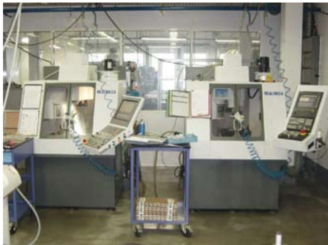
Côte-à-côte dans l'atelier de Dampierre, les deux centres d'usinage Realmeca RV2 ont permis à Silvant une véritable progression technologique en usinage 5 axes à grande vitesse. Les créateurs du luxe apprécient particulièrement la précision des contours et les états de surface ainsi proposés par Silvant sur leurs pièces.
