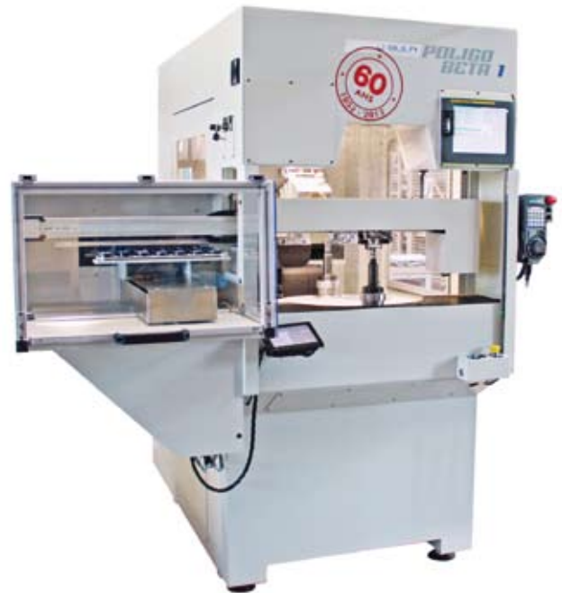
Le centre Poligo Beta de Bula Technologie permet le polissage, l'avivage, le brossage et l'ébavurage.
