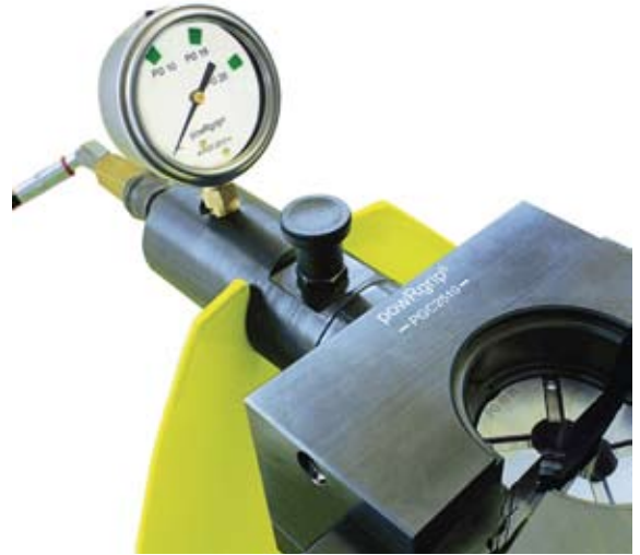
Les porte-pinces et les pinces PG6 sont compatibles avec l'unité de serrage PGC 2506 de Rego-Fix.
