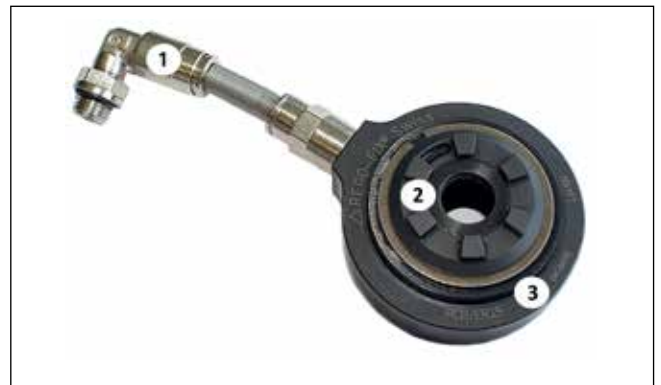
1) Amenée de liquide de refroidissement, 2) Corps intérieur rotatif et 3) Corps extérieur non-rotatif.
