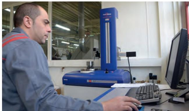
De manière à garantir une précision de l'ordre du micromètre, les broches sont contrôlées avec des outils d'une résolution allant jusqu'au nanomètre.
