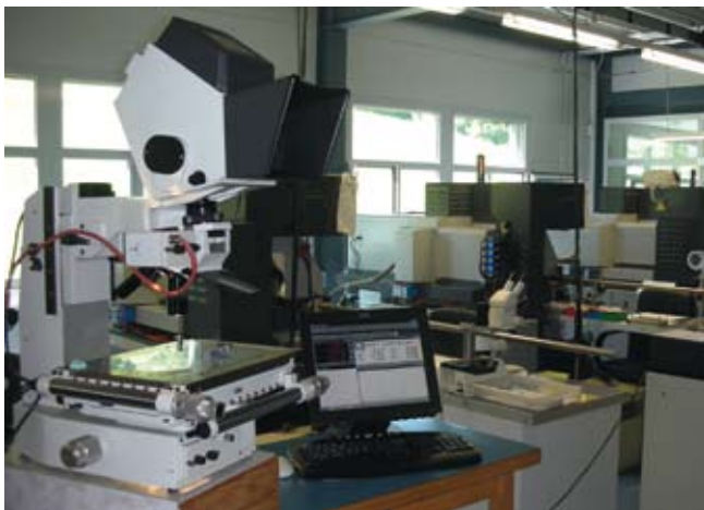
Les contrôles de qualité des pièces en cours de production s'effectuent au sein même de l'atelier. Au premier plan un système de contrôle optique.
