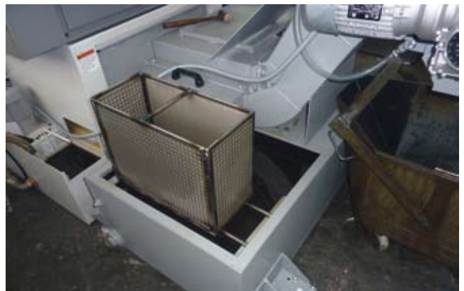
Autre aspect qui va simplifier la vie des utilisateurs : le filtre peut être installé en position d'égouttage, ceci même si un autre filtre est en position de travail.
